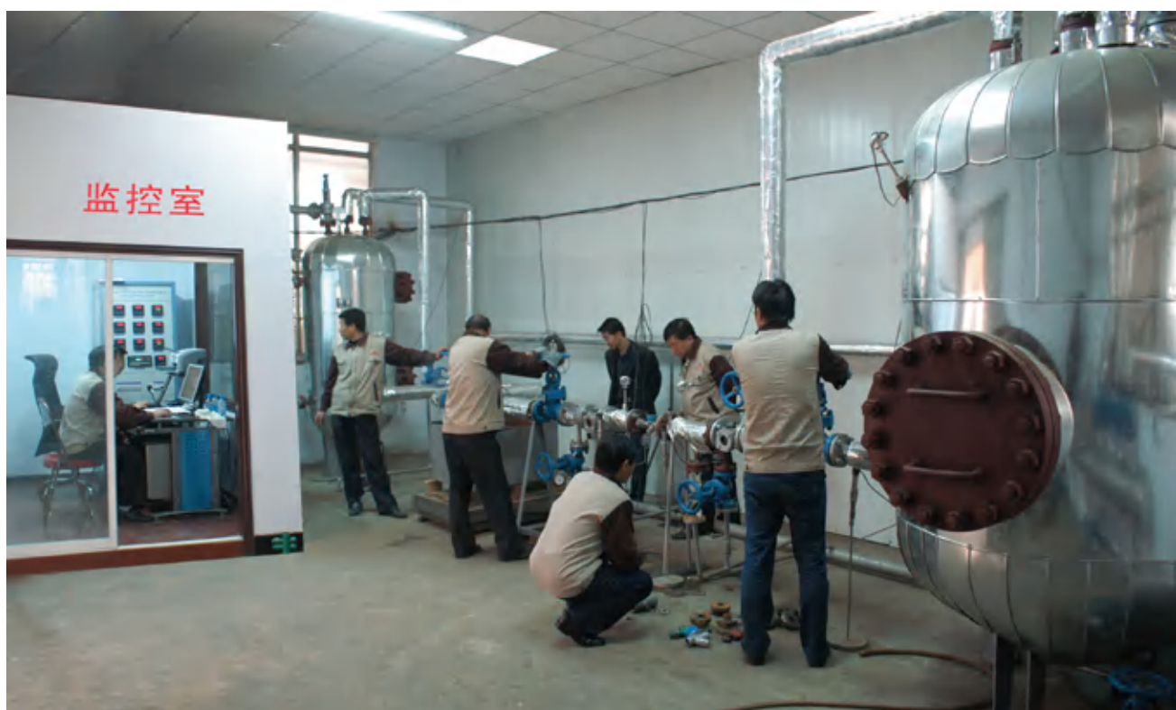
国内领先的疏水阀型式试验装置
